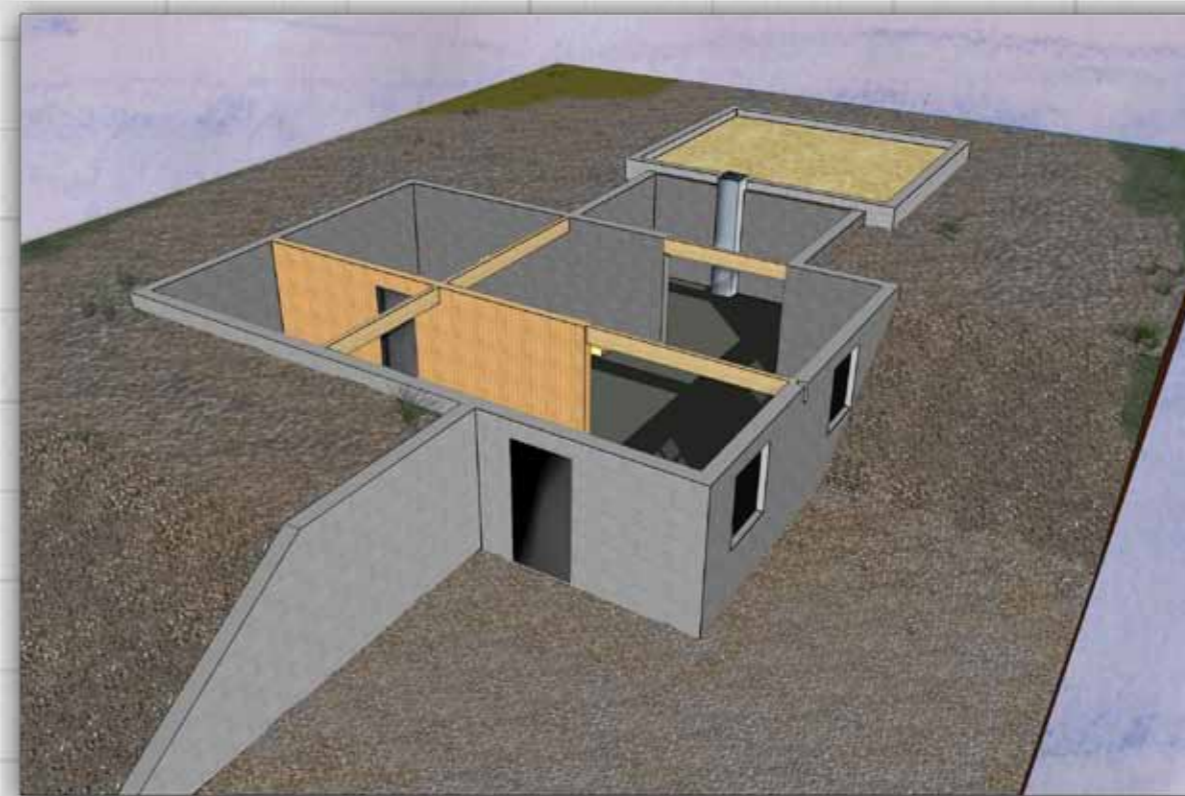
Utsnitt av kjeller med støttemur
